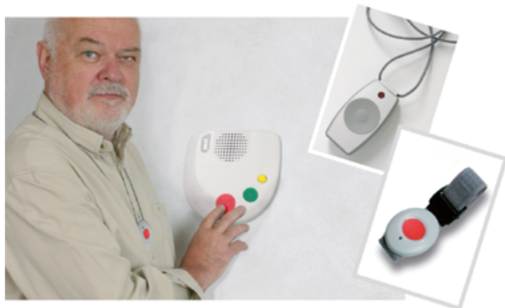
Ein Knopfdruck verbindet den Teilnehmer direkt mit der HausNotRuf-Zentrale.
